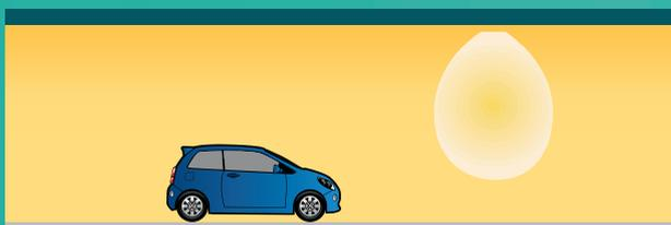
**Iluminación a contraluz** se proyecta hacia el flujo de tráfico. Esto se traduce en un objeto de alto contraste, por lo que muestra un objeto oscuro contra un fondo iluminado. Debido a las grandes diferencias de frecuencia en los niveles de iluminación en las entradas de los túneles. A pesar de los estándares, pueden resultar con un mayor deslumbramiento. Este tipo de iluminación no es adecuada para cornisas de montaje en el túnel.
