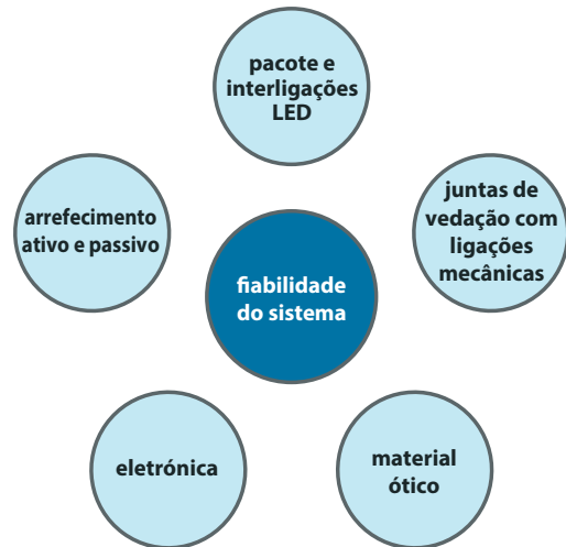
Figura 5 – Componentes importantes da luminária com tecnologia LED
