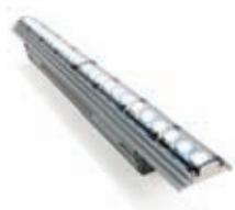
Светильники серии iW Graze Powercore – это линейные светодиодные управляемые светильники с варьируемой цветовой температурой белого света, предназначенные для освещения городских стен, фасадов зданий и других объектов городской архитектуры. В состав светильника входят светодиоды холодного и теплого белого света, что позволяет варьировать цветовую температуру в диапазоне от 2700 K до 6000 K.
