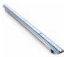
Светильники серии Color Graze Powercore – это линейные светодиодные управляемые RGB-светильники для освещения городских стен, фасадов зданий и других объектов городской архитектуры. За счет использования особых технологий качественное смешивание цветов происходит уже на расстоянии 152 мм от светильника. Компактный корпус прибора и минимум кабельной проводки за счет использования технологии Powercore превращают эту серию светильников в незаметное на фасадах зданий решение.
