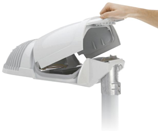
L'attacco palo del Selenium LED è reversibile e offre massima flessibilità nelle applicazioni retrofit grazie alle tre posizioni di inclinazione. L'attacco è adatto per pali e bracci con diametro da 48 a 60 mm:
