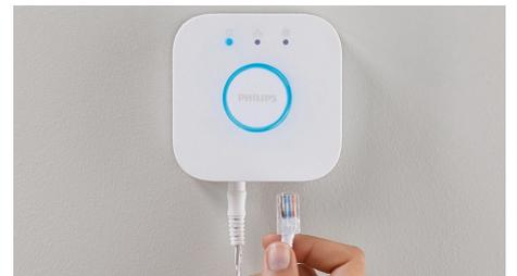
El Bridge Hue\*, que es el corazón de tu sistema de iluminación inteligente, conecta tus luces Hue White & Color Ambience a tu aplicación y a la Sync Box, lo que te permite personalizar y guardar la configuración de luz durante la sincronización. \*La Sync Box solo es compatible con el Hue Bridge V2 cuadrado.
