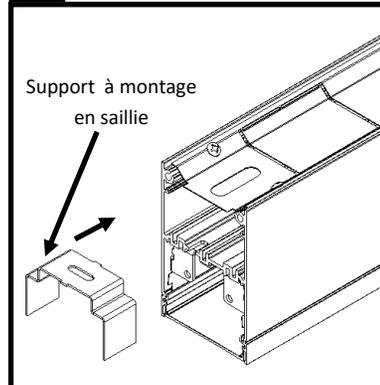
Insérer les supports à montage en saillie à plus ou moins 2 pouces du module 1. Vous assurer que le support s'engage et glisse à l'intérieur de la partie supérieure du canal du luminaire. Vous assurer que la fente du réflecteur du luminaire s'aligne avec la fente du support de montage.
