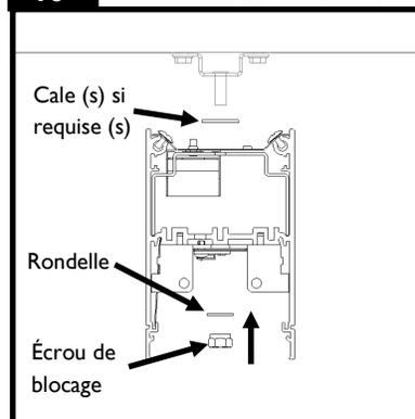
Soulever le module 1 au plafond, aligner le support de plafond de 1/4 po-20 avec la fente du boîtier et la fente du support en saillie.
