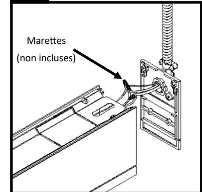
Pour la boîte de jonction montée en saillie, connecter le conduit et les connecteurs requis (non inclus) à l'embout percé.
