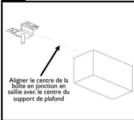
Installer la boîte de jonction en saillie tel que requis. Pour une installation plus propre et un meilleur alignement des modules installés, centrer la boîte de jonction et le conduit de sortie avec la ligne centrale des supports de plafond.
