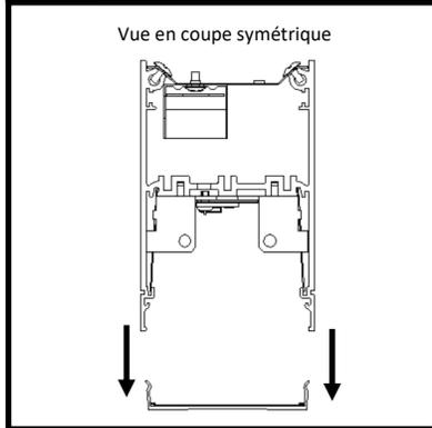
Retirer la lentille du luminaire et la mettre de côté jusqu'à la fin de l'installation. Utiliser des gants de coton pour manipuler la lentille et la déposer dans un endroit propre. **Note** : Ne pas mélanger les lentilles symétriques et asymétriques puisqu'elles sont différentes.
