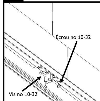
Rattacher les modules de luminaires ensemble à l'aide des deux vis mécaniques no 10-32 et des deux écrous no 10-32 inclus. Resserrer jusqu'à ce que le joint soit bien serré. **Note : Ne pas trop serrer.**
