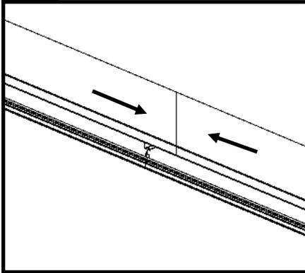
Vous assurer que toutes les connexions sont bien rattachées et que tous les fils sont rentrés dans la cavité du luminaire. Rapprocher doucement les luminaires ensemble. Les modules 1 et 2 joints, rattacher l'extrémité non jointe du module au plafond.
