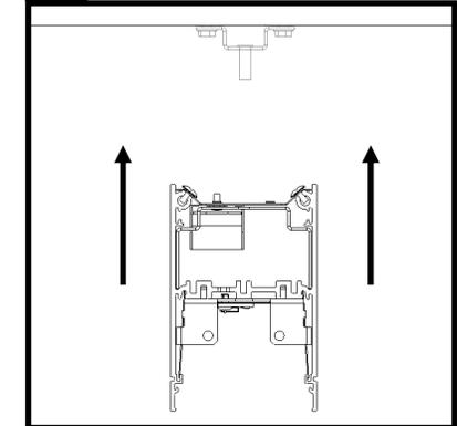
Soulever le module 1 vers le plafond en maintenant les deux extrémités à quelques pouces sous le plafond.
