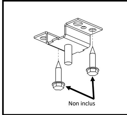
Déterminer l'emplacement des supports de plafond. Utiliser le tableau de la page 1 pour les dimensions. Centrer et installer les supports de plafond sur la structure (solives ou traverses) à l'aide des outils adéquats (non inclus).
