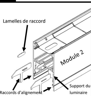
Le module 2 sur le plancher, piquer les lamelles de raccord dans la chasse de vis à l'intérieur supérieur. Vous assurer que plus de la moitié des lamelles de raccord soient insérées à l'intérieur du luminaire. Insérer les raccords d'alignement dans la chasse de vis à l'intérieur inférieur tel qu'illustré. Vous assurer que l'orientation permettra l'insertion de la languette de verrouillage à l'intérieur du support du luminaire.
