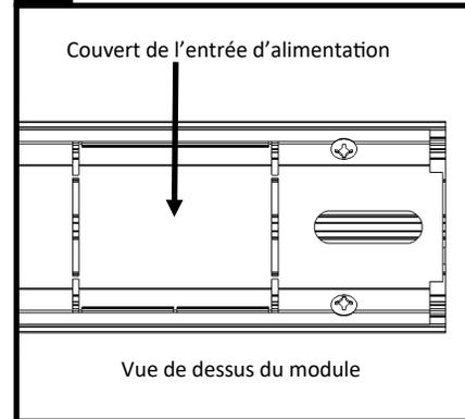
Choisir la méthode d'alimentation du luminaire et son emplacement. Pour l'installation d'une boîte de jonction encastrée, enfoncer la languette du couvert d'alimentation à l'aide d'un tournevis plat à l'extrémité désirée seulement.
