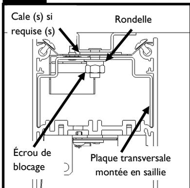
Sous le luminaire, rattacher la rondelle ID de 1/4 po et l'écrou hexagonal 1/4 po-20 à la solive 1/4 po-20 du support de plafond. Si le plafond n'est pas à niveau, installer les cales fournies et resserrer à l'aide des écrous hexagonaux 1/4 po-20.
