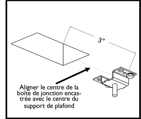
Pour une boîte de jonction de 2 po x 4 po encastrée, aligner et centrer avec les supports de plafond. Installer avec la section plus longue parallèle à la longueur du module de luminaire. Vous assurer que la boîte de jonction est à 3 po du support de plafond.
