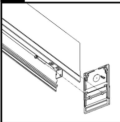
Glisser l'embout dans l'extrémité du module de luminaire et rattacher par en-dessous à l'aide des deux vis no 8-32 X 5/16 po. Serrer les vis jusqu'à ce que le joint soit serré.
