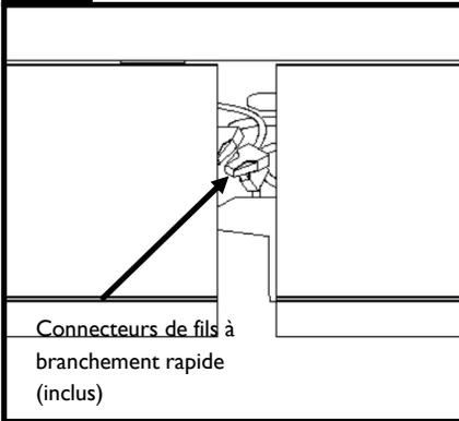
En supportant le module 2, compléter les connexions de filage à l'aide des connecteurs de fils à branchement rapide.
