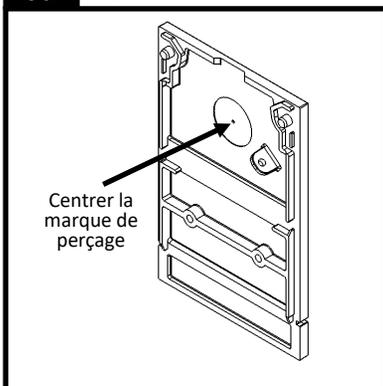
Pour l'installation des boîtes de jonction en saillie, alimenter le module par l'embout. Utiliser un ruban masqué sur toutes les surfaces extérieures, tourner le luminaire et le placer sur un bloc de bois. Aligner avec la marque de perçage tel qu'illustré et percer un trou de 7/8 po de diamètre.
