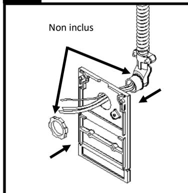
Préparer l'alimentation en installant le conduit et les connecteurs (non inclus) dans l'embout percé. Pour les connexions d'alimentation et l'installation de l'embout, vous reporter aux étapes 13 et 14.
