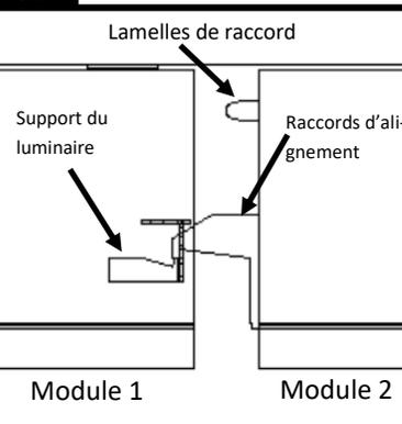
Joindre les modules et enclencher les raccords d'alignement du module 2 sur le support du luminaire du module 1. **Note : Ne pas rattacher le module 2 au plafond à cette étape.**
