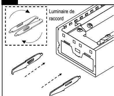
Pour chaque luminaire additionnel de l'enfilade, installer le support de montage c.a. tel que décrit dans l'étape 2e le plus loin du luminaire suspendu existant. **À l'extrémité la plus proche du luminaire suspendu existant,** insérer le mécanisme de raccord d'alignement dans la traverse (les mécanismes de raccord se verrouilleront en place).
