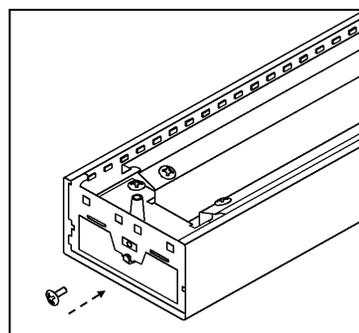
À l'aide des ferrures incluses, rattacher les supports au luminaire.
