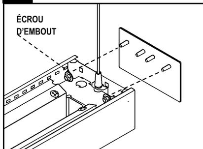
À l'aide des ferrures incluses, rattacher l'embout au premier et au dernier module de chaque enfilade. **REQUIERT UN TOURNEVIS À DOUILLE DE 1/162 PO OU UNE CLÉ.**
