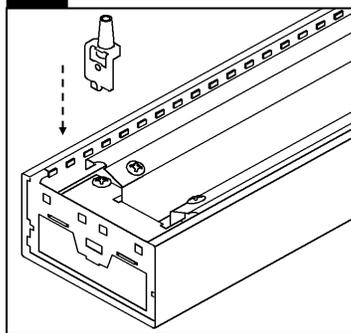
Rabattre les languettes rectangulaires du couvert de filage et insérer le support de montage c.a. dans la partie supérieure. Soulever le support jusqu'à ce que la languette de sécurité s'engage.
