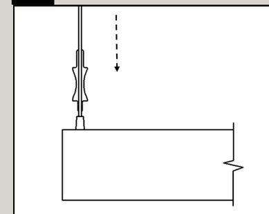
**NIVELER VERTICALEMENT** : Supporter le luminaire par-dessous et utiliser la pince de câble incluse pour effectuer les réglages en hauteur finaux.
