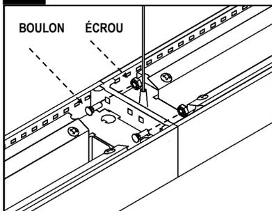
**GLISSER LES MODULES ENSEMBLE** : à l'aide des boulons et écrous rattacher le raccord par le dessus.
