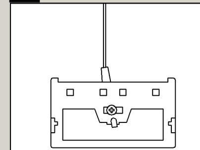
**NIVELER HORIZONTALEMENT** : desserrer l'attache en dessous du mécanisme et mettre à niveau tel que requis. Resserrer l'attache une fois le luminaire nivelé.
