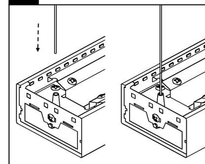
Soulever le premier luminaire jusqu'au plafond, 2 personnes sont requises. À chaque extrémité du module insérer le câble d'aéronef dans le dispositif de réglage du câble. Le dispositif de réglage s'engagera automatiquement et retiendra le câble. **Ne pas forcer le câble dans le dispositif.** Voir directives A (page 3) pour plus de détails.
