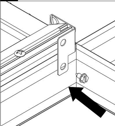
Sécuriser l'appareil aux grilles avec la vise auto perçante 8x1/4" (fournies dans l'emballage).
