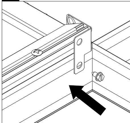
Sécuriser l'appareil aux grilles avec la vise auto perçante 8x1/4" (fournies dans l'emballage).
