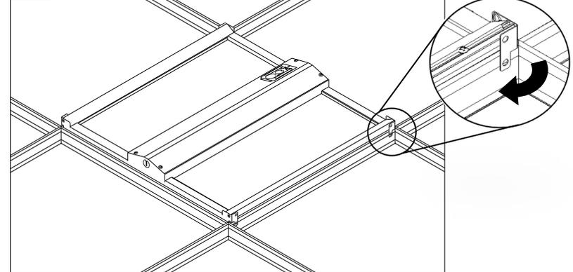
Déposer l'appareil sur les gilles (T-grilles). Plier les pattes sur les grilles.
