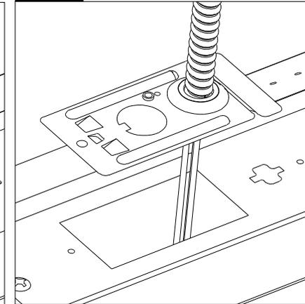
En option, le flex fouet est pré-câblée à l'appareil. Monter la plaque de passage de câble à l'emplacement de l'appareil. Faire les branchements électriques à l'autre bout du fouet selon les codes locaux et nationaux de la construction de bâtiment.
