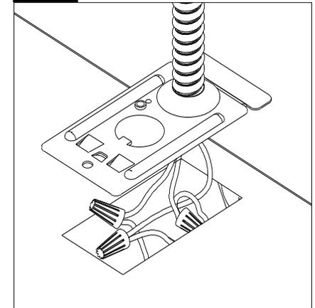
Enlever la plaque de passage de câble. Brancher l'alimentation électrique aux câbles d'appareil. Remonter la plaque de passage de câble.
