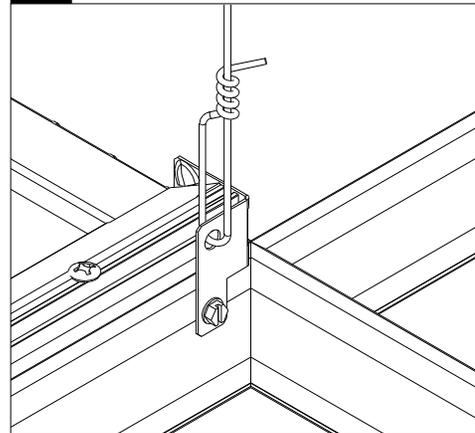
Attacher l'appareil avec le câble de grille ou un équivalent conforme aux codes locaux et nationaux de la construction de bâtiment.
