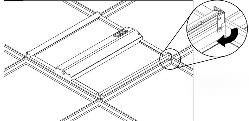
Déposer l'appareil sur les gilles (T-grilles). Plier les pattes sur les grilles.
