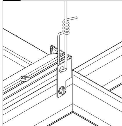
Attacher l'appareil avec le câble de grille ou un équivalent conforme aux codes locaux et nationaux de la construction de bâtiment.
