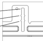
Le système de montage est conçu pour installer dans un profilé d'une hauteur de 1/2 po, 7/8 po ou 1 1/2 po.
