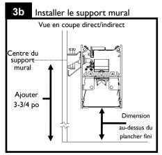
Déterminer la dimension au-dessus du plancher fini et ajouter 3 3/4 po pour la configuration directe/indirecte. Trouver le centre, niveler et centrer les supports muraux. Installer sur la structure en utilisant les ferrures appropriées (non incluses).
