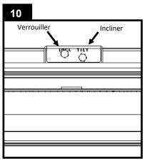
Après l'installation du module 1 ajuster la vis d'inclinaison pour niveler le luminaire.
