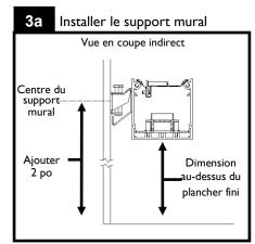
Déterminer la dimension au-dessus du plancher fini et ajouter 2 po pour la configuration indirecte. Trouver le centre, niveler et centrer les supports muraux. Installer sur la structure en utilisant les ferrures appropriées (non incluses).
