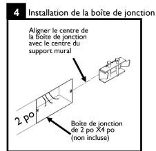
Déterminer l'emplacement de la boîte de jonction de 2 po x 4 po (non incluse). Avant d'installer vous assurer que le centre de la boîte de jonction est centré avec le centre du support mural. La position recommandée de la boîte de jonction est de 6 à 8 po de l'extrémité du luminaire.
