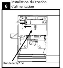
Déterminer l'emplacement de l'alimentation sur le luminaire. Rattacher à l'aide de la rondelle de 1/2 po tel qu'illustré.
