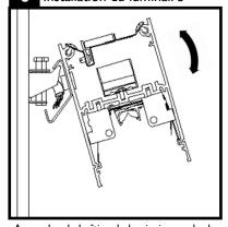
Accrocher le boîtier du luminaire sur le dessus du support mural et incliner doucement vers le bas tout en supportant le boîtier. Le boîtier devrait s'engager sur tous les supports muraux et se verrouiller en place.
