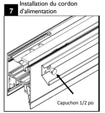
Installer le capuchon de 1/2 po inclus à l'extrémité opposée du boîtier du luminaire.
