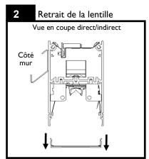
Retirer la lentille du luminaire et la mettre de côté jusqu'à la fin de l'installation. Utiliser des gants de coton pour manipuler la lentille et la déposer dans un endroit propre.
