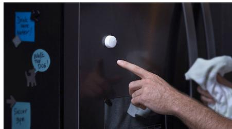
Gracias a la tecnología inalámbrica, el botón Philips Hue Smart button se instala en unos segundos en cualquier lugar de tu hogar. Sustituye un interruptor por la placa de montaje incluida o utiliza el montaje mini para colocarlo en cualquier superficie. Si prefieres que sea portátil, no hay ningún problema: el Hue Smart button es magnético y puedes colocarlo en una superficie magnética, como el refrigerador.
