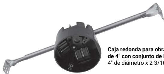
Caja para luminario/ventilador redondo de 4" de obra nueva no metálica 4" de diámetro x 2-3/16" (102mm x 56mm)
