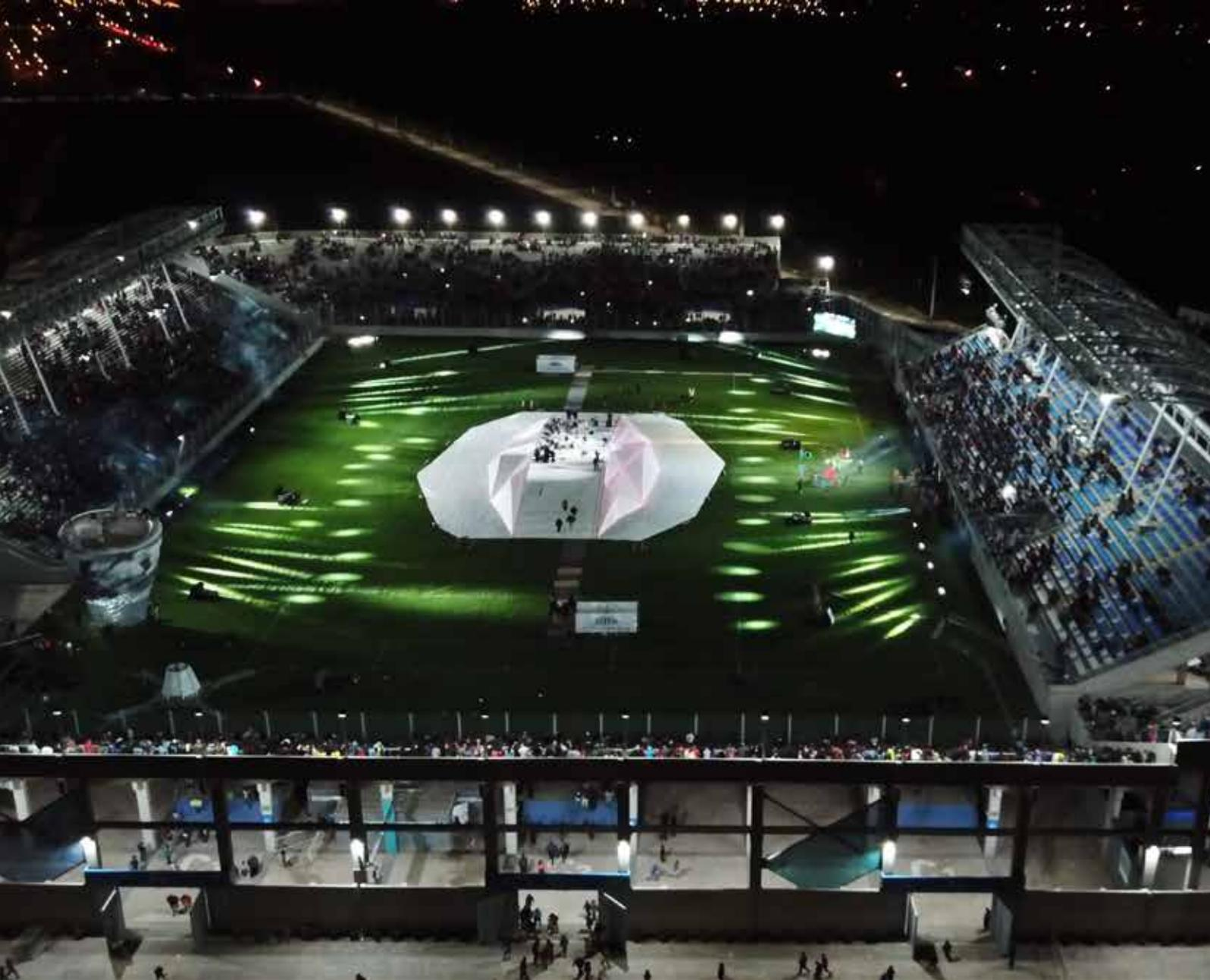
La solución de iluminación del Estadio Único minimiza los costos de energía gracias a la eficiencia de las luminarias Philips ArenaVision LED. Esta gama de productos proporciona excelentes rendimientos lumínicos, con una temperatura de color de 5.700K y un índice de reproducción cromática excelente (IRC de 90).
