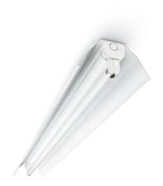
Lineco TMSO22 est une réglette apparente économique et fonctionnelle pour 1 ou 2 lampes fluorescentes TL-D. L'installation est rapide et s'effectue sans outil, d'une seule main. Le bloc de contact repositionnable permet une flexibilité de connexion (avec entrée de câble centrale ou via les embouts d'extrémités). Une vaste palette d'accessoires à encliqueter est disponible.
