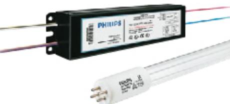
飞利浦 TUV XPT汞齐灯系统包括飞利浦 TUV低压高强汞齐紫外线杀菌灯管和一个为灯管量身定制的电子镇流器。电子镇流器还具有调节灯管功率的功能，确保了不同要求下飞利浦 TUV低压高强汞齐紫外线杀菌灯管的性能发挥，使灯管具有更高的可靠性和更长的使用寿命。
