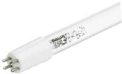
飞利浦 TUV T5紫外线灯管是用于专业用水和空气消毒装置的单端或双端UV-C紫外线杀菌灯管。灯管直径仅为16毫米，可用于小型系统设计，设计的灵活性高。TUV T5紫外线杀菌灯管可在有效寿命期间内提供几乎恒定的UV-C输出。
