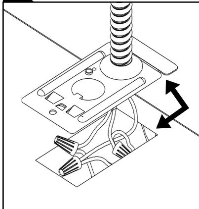
Retirer les fils préinstallés de la plaque d'accès. Brancher l'alimentation avec les fils inclus.
