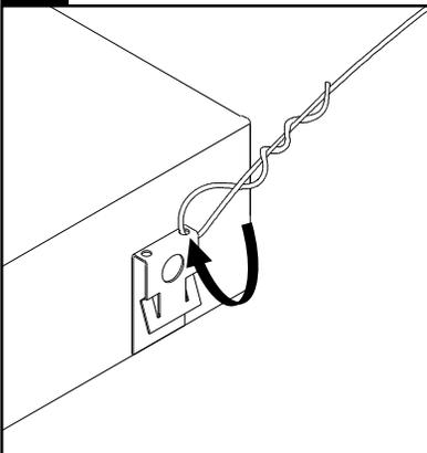
Rattacher le luminaire avec le fil de la grille ou avec un équivalent approuvé par les codes du bâtiment locaux ou nationaux.
