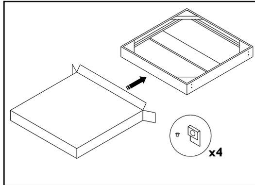
Retirer le luminaire de la boîte et trouver les ferrures. Pendant l'installation garder les espaceurs en place.
