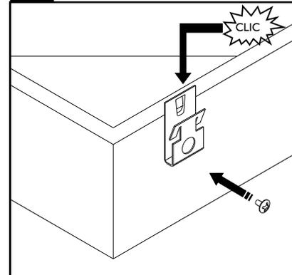
Rattacher les agrafes sur le luminaire à l'aide de la vis incluse.
