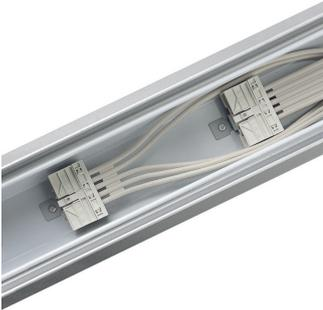
Maxos 4MX656 TL5-Standard-Tragschienenabschnitt mit zwei 5-adrigen Flachbandkabeln (2 x 5 x 1,5 / 2 x 5 x 2,5), zur Schaffung verschiedener Zonen in einer Anwendung oder zur Verwendung von zentralen Notbeleuchtungssystemen
