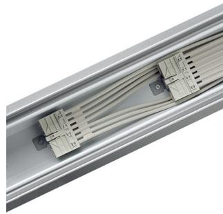
Maxos 4MX656 TL5-Standard-Tragschienenabschnitt mit zwei 7-adrigen Flachbandkabeln (2 x 7 x 1,5 / 2 x 7 x 2,5), zur Schaffung verschiedener Beleuchtungszonen mit Dimm-Funktion oder für eine separate Notbeleuchtung
