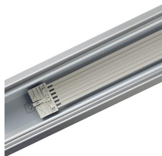
Maxos 4MX656 TL5-Standard-Tragschienenabschnitt mit 7-adrigem Flachbandkabel (7 x 1,5 / 7 x 2,5), für Dimmfunktion (1-10V), DALI oder Notbeleuchtung mit dezentraler Batterie
