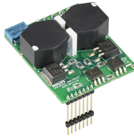
DGLM202 2 x 2 A Leading edge dimmer module
