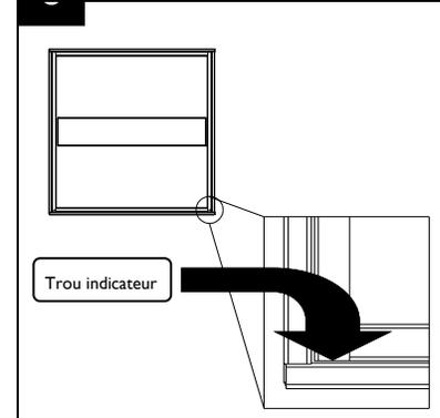
Localiser les trous indicateurs sur le cadre de porte de la lentille. Ces marqueurs sont situés à l'opposé du mécanisme à charnière des portes.
