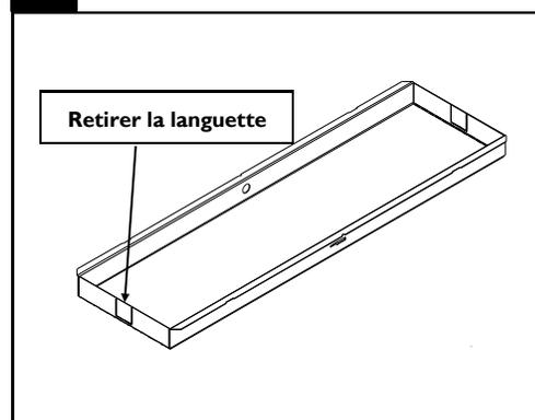
Du côté de l'entrée du conduit du couvert de fils retirer la languette afin de faire pénétrer le conduit dans le canal du régulateur
