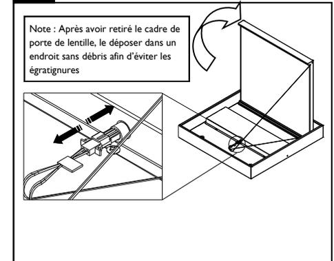
Tirer le cadre de porte de la lentille vers le haut vers le côté du marqueur. Débrancher le faisceau de câbles et retirer le cadre de porte.
