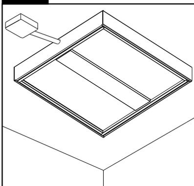
Brancher et réinstaller le cadre de porte de lentille. Aligner le cadre de la porte afin qu'il affleure le dessous du boîtier.
