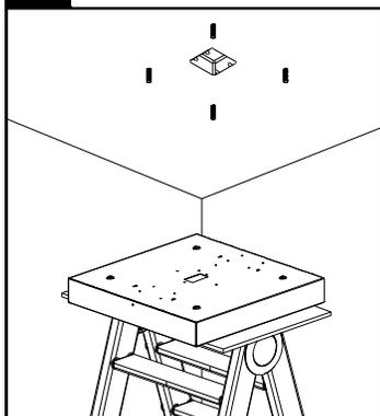
Placer le boîtier sur l'échelle ou la plateforme sous l'emplacement de l'installation
