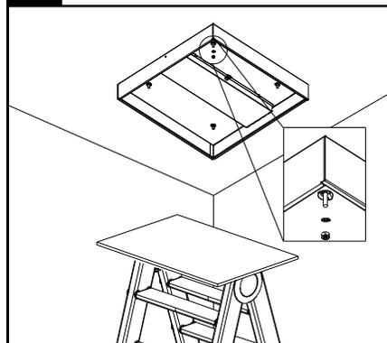
Rattacher le boîtier aux ancrages à l'aide d'écrous hexagonaux de 1/4 po-20 et de rondelles (non inclus)
