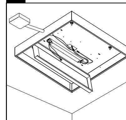
Terminer les connexions électriques et réinstaller le couvert de fils
