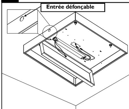
Retirer le couvert de fils. Pour l'entrée du conduit, enfoncer l'entrée défonçable dans le côté du boîtier
