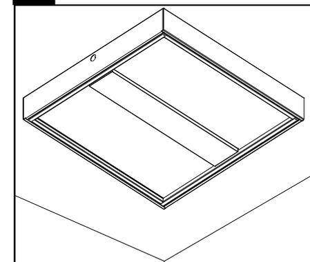
Brancher et réinstaller le cadre de porte de lentille. Aligner le cadre de la porte afin qu'il affleure le dessous du boîtier.
