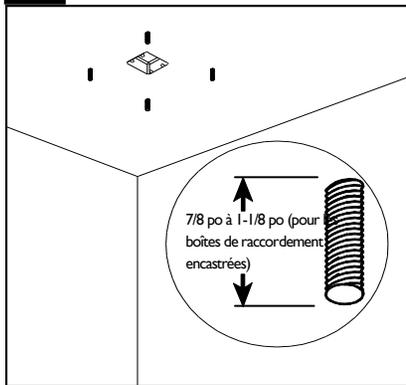
Utiliser les dimensions d'installation à la page 3 pour marquer et percer les emplacements recherchés. Installer les ancrages 1/4 po-20 (non inclus) dans le plafond en vous assurant qu'ils ressortent de 7/8 po à 1-1/8 po du plafond et que le trou d'accès pour les fils soit au-dessus de la boîte de raccordement.
