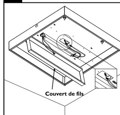
Retirer le couvert de fils du boîtier. Effectuer toutes les connexions électriques nécessaires et réinstaller le couvert de fils.
