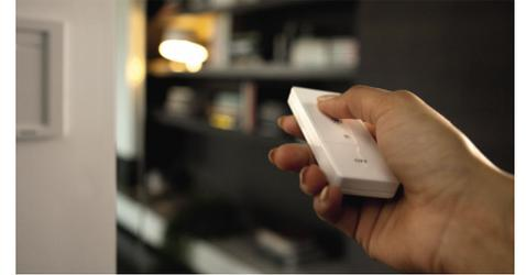
Используя пульт дистанционного управления Hue с питанием от батарейки можно одновременно управлять десятью умными лампами. Этот выключатель, который можно извлечь из настенного крепления, чтобы использовать в качестве пульта дистанционного управления, позволяет приглушать свет или делать его ярче, а также переключаться между предустановленными световыми режимами.
