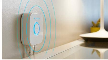
El Hue Bridge es un componente esencial de un sistema de iluminación inteligente personal de Philips Hue. Es el cerebro del sistema que se comunica con las lámparas inteligentes y la app Hue para garantizar que todo funcione conjuntamente. También permite funciones de automatización de hogar inteligente tales como temporizadores y rutinas de programación.
