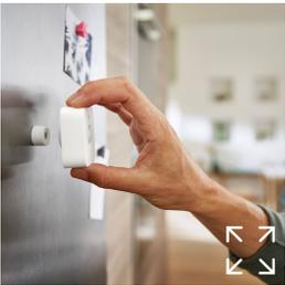
沒有任何纜線，因此您可以將它放在家中的任何位置。動作感應器是由電池供電，因此完全無線而且可輕鬆安裝在家中的任何位置。只要幾分鐘就可以完成設定。您可以將它隨意安置在架子、邊桌上，或使用內附的螺絲將它安裝在牆壁或天花板。您甚至可以使用內附的磁鐵將它黏貼在冰箱等金屬表面。您可以將感應器調整為適合的方向，輕鬆調整偵測角度
