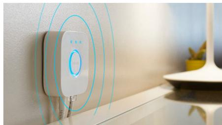
Блок управления блока управления является основной частью системы умного освещения Philips Hue. Этот главный компонент взаимодействует с умными лампами и приложением Hue, обеспечивая правильную работу всей системы. Кроме того, блок управления Hue Bridge поддерживает функции автоматизации умного дома, такие как расписание ежедневных занятий и таймеры.
