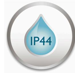
Diese Außenleuchte von Philips wurde speziell für feuchte Außenumgebungen entwickelt. Sie wurde streng auf Wasserfestigkeit getestet. Die Schutzart IP44 besagt, dass sie für den Schutz gegen das Eindringen von Staub und Spritzwasser zertifiziert wurde. Daher eignet sie sich perfekt für den allgemeinen Einsatz im Freien.
