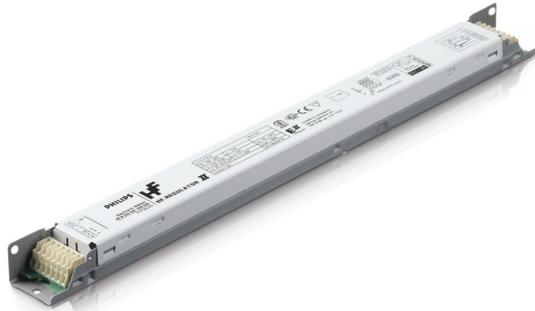
Ballast électronique haute fréquence pour la gradation, utilisant le protocole analogique (1-10 V) pour lampes TL5 HE/HO et TL5 Eco
