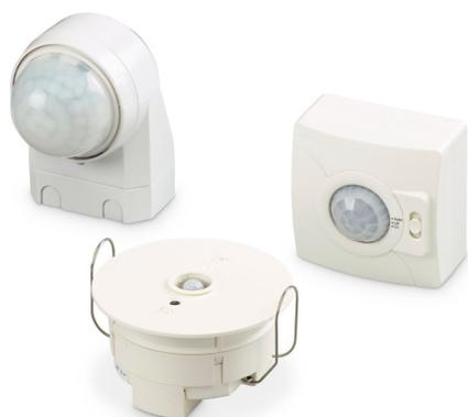
Le système OccuSwitch est un détecteur de mouvement qui permet d'éteindre les luminaires dans un local ou un espace lorsque celui-ci est inoccupé et d'économiser ainsi jusqu'à 30 % d'électricité. Le système OccuSwitch peut commuter jusqu'à 6A de charge max. et contrôler une zone allant de 20 et 25 m<sup>2</sup>. Des connecteurs amovibles permettent de faciliter l'installation des OccuSwitch. Un câble Wieland est disponible séparément pour une installation encore plus simple, rapide et sûre
