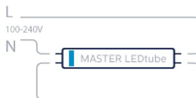
Votre luminaire a un ballast incompatible ou défectueux ? Pas de problème. Retirez le ballast (et le starter dans le cas d'un EM-VSA) et installez le tube LED directement sur 230V. Utilisez un tube LED marqué d'un anneau bleu.
