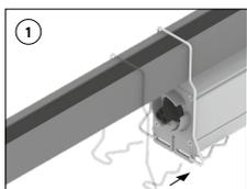
1) Hook on 2 mounting brackets (**A and A**) onto the C-profile. Put the 1st module over the C-profile. Slide the 1st bracket (**A**) into the end cap of the module. / Accrochez 2 étriers (**A et A**) sur le profilé C. Mettez le premier module sur le profilé C. Glissez le premier étrier (**B**) dans l'extrémité du module.
