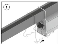
1) Hook on 2 mounting brackets (**A and A**) onto the C-profile at 1.25 m pitch. Put the 1st module over the C-profile. Slide both brackets into both end caps of the module. / Accrochez 2 étriers (**A et A**) sur le profilé C écarté de 1,25m. Mettez le premier module sur le profilé C. Glissez les deux étriers dans les deux extrémités du module.
