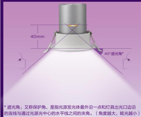
\* 遮光角：又称保护角，是指光源发光体最外沿一点和灯具出光口边沿的连线与通过光源光中心的水平线之间的夹角。（角度越大，眩光越小）
