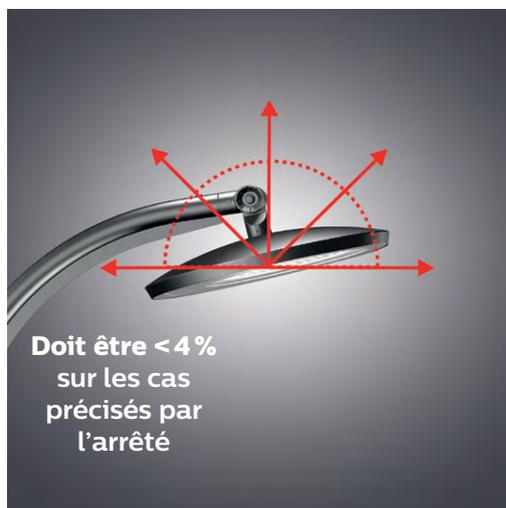
Donnée tirée de l'étude d'éclairage, valeur de l'ULR avec le luminaire en position réelle de montage (inclinaison du luminaire prise en considération)
