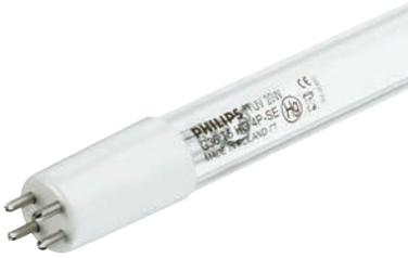
I modelli TUV T5 sono lampade UVC (germicide) a terminazione doppia o singola utilizzate nelle unità di disinfezione dell'acqua e dell'aria di tipo professionale. Grazie al diametro di soli 16 mm, la lampada può essere impiegata in sistemi di piccole dimensioni e in modo flessibile. Le lampade TUV T5 offrono un'emissione quasi costante di raggi UV per tutta la loro durata di vita.
