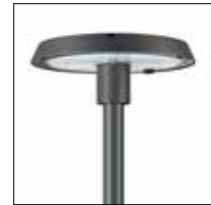
BDP260: testa-palo, colore Grigio Scuro Philips, classe II, non regolabile, completo di SPD, attacco testa palo 60 mm
