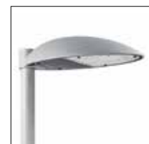
BPP435: testa palo, colore Grigio Silver, classe II, non regolabile, completo di SPD e connettore esterno di alimentazione. Attacco testa-palo 60-76 mm
