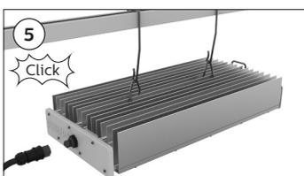
Connect the female connector of the main power cable <CLICK> and connect this main power cable to the power grid. Make sure to relief the stress from the cable connections, by introducing a loop (see install pictures on the first page). / Branchez le connecteur du câble d'alimentation <CLICK> et raccordez ce câble d'alimentation sur le réseau. Enlevez l'éventuel tension du câble en y mettant une boucle (veuillez voir les images d'installation sur la première page).
