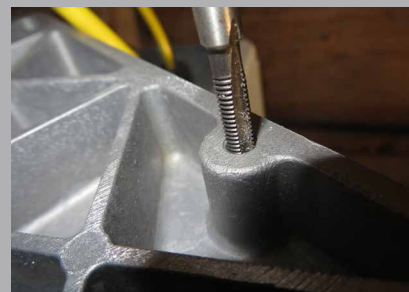
Figuur 2: Tappen van de schroefdraad
