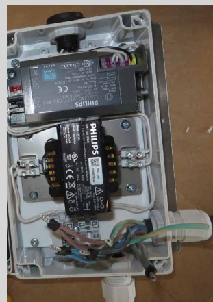
Figuur 1: Aansluiten van de bedrading in de connectorbox
