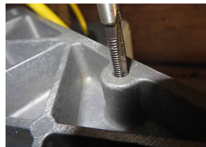
Figuur 2: Tappen van de schroefdraad
