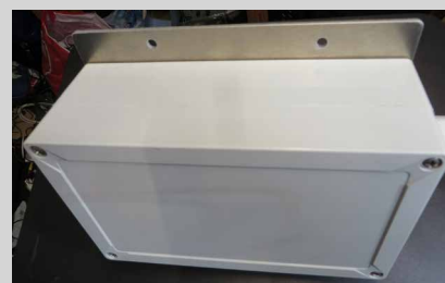
Figuur 3: Connectorbox met montageplaat
