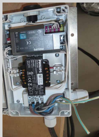
Figuur 1: Aansluiten van de bedrading in de connectorbox
