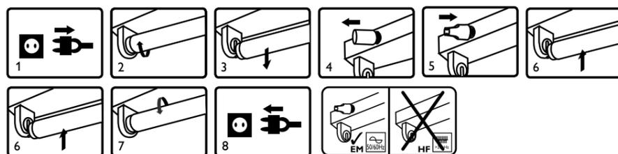
Для светильников с 2 лампами и одним ЭМПРА или с 4 лампами и двумя ЭМПРА
