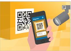
Signify Service Tag est un système unique basé sur QR qui permet d'identifier sans équivoque chaque luminaire et fournit des informations sur la maintenance, l'installation et les pièces de rechange pour chaque luminaire. En scannant le code QR sur les lampes Philips, vous avez un accès en toute simplicité. Signify Service Tag vous fait gagner un temps précieux et vous aide à éviter les erreurs.
