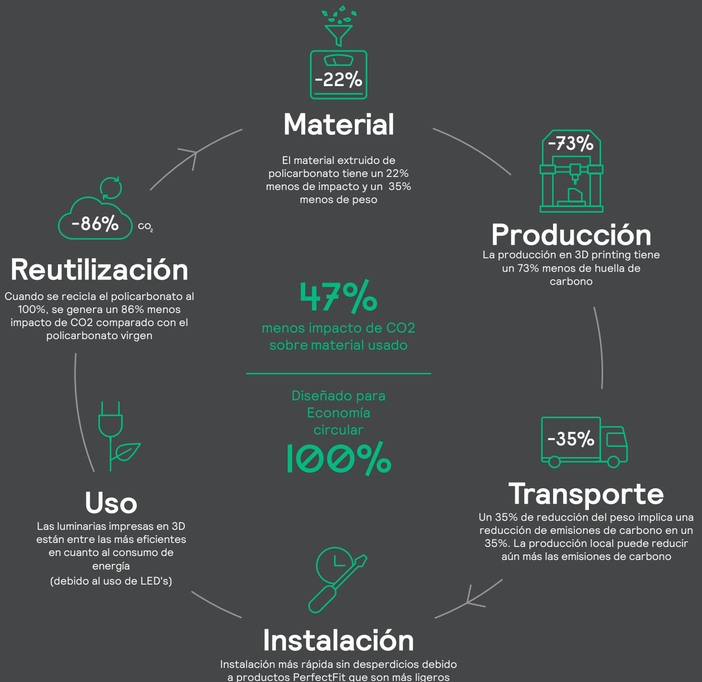
Datos basados en la comparación de la carcasa y el dissipador de calor de un proyector impreso en 3D frente a la carcasa de un proyector de aluminio fundido a presión producido tradicionalmente. Los datos de otros productos variarán.
