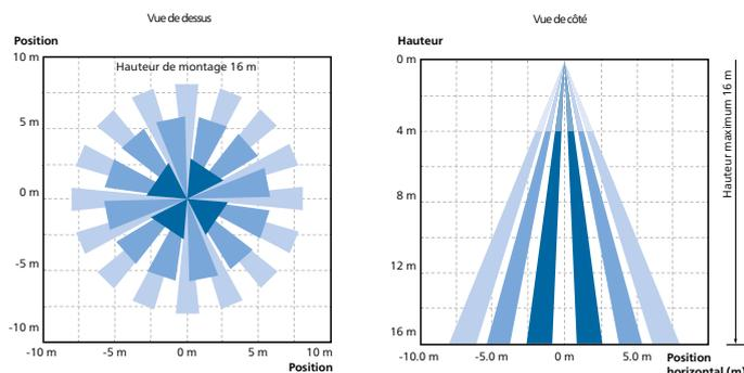
Zone de détection du capteur intégré
