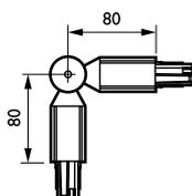
Permet de relier deux rails dans le même plan horizontal ou dans 2 plans différents après démontage et rotation des embouts.
