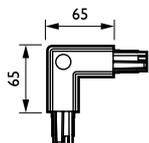
Permet de relier deux rails en L, 230 V/16 A par conducteur.
