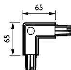
Permet de relier deux rails en L, 230 V/16 A par conducteur.
