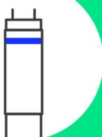
Ein Ring: KVG/VVG/230V (Elektromagnetisches Vorschaltgerät oder direkter Betrieb an 230V)
