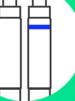
Kein Ring/ein Ring: 230V (Elektromagnetisches Vorschaltgerät oder direkter Betrieb an 230V)
