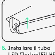
5. Installare il tubo LED (InstantFit HF o UN) con l'apertura della luce rivolta verso il basso
