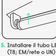
5. Installare il tubo LED (T8; EM/rete o UN) con l'apertura della luce rivolta verso il basso
