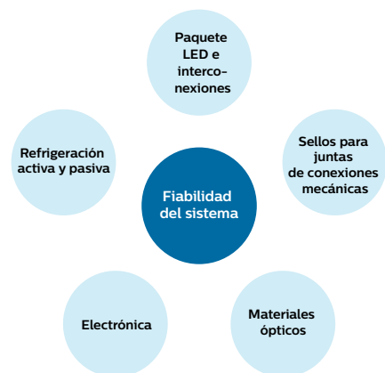
Figura 2: Componentes críticos de luminaria basada en LED
