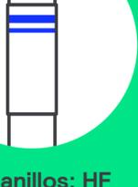
Dos anillos: HF (balasto electrónico de alta frecuencia)
