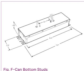
Fig. F-Can Bottom Studs
