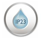
Cet éclairage extérieur Philips est spécialement conçu pour les espaces extérieurs humides et a fait l'objet d'essais rigoureux afin de garantir sa résistance à l'eau. Le niveau IP est composé de deux chiffres : le premier se rapporte au niveau de protection contre la poussière, et le second contre l'eau. Cet éclairage extérieur est IP23 : il résiste aux projections d'eau et convient parfaitement à l'éclairage d'un porche ou d'une terrasse couverte.
