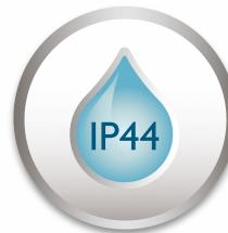
Esta lámpara para exteriores de Philips se ha diseñado para entornos húmedos y se ha sometido a rigurosas pruebas para garantizar su impermeabilidad. El nivel IP se describe mediante dos cifras: la primera se refiere al nivel de protección frente al polvo y la segunda frente al agua. Esta lámpara se ha diseñado con el nivel IP44, por lo que está protegida frente a las salpicaduras de agua. Este producto es habitual e ideal para su uso general en exteriores.
