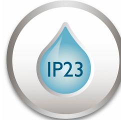
Cet éclairage extérieur Philips est spécialement conçu pour les espaces extérieurs humides et a fait l'objet d'essais rigoureux afin de garantir sa résistance à l'eau. Le niveau IP est composé de deux chiffres : le premier se rapporte au niveau de protection contre la poussière, et le second contre l'eau. Cet éclairage extérieur est IP23 : il résiste aux projections d'eau et convient parfaitement à l'éclairage d'un porche ou d'une terrasse couverte.
