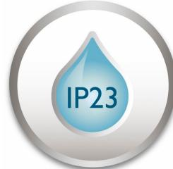
Cette lampe d'extérieur Philips est spécialement conçue pour les environnements extérieurs humides et a été rigoureusement testée pour garantir sa résistance à l'eau. Son indice de protection IP23 signifie qu'elle a été certifiée comme offrant une protection contre les projections d'eau. Elle est donc idéale pour éclairer une véranda ou un perron.
