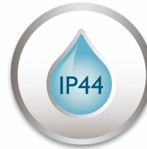
Questa lampada Philips per esterni è stata progettata per gli ambienti umidi all'aperto ed è stata sottoposta a rigorosi test per garantire l'impermeabilità. Il livello IP è indicato da due cifre: la prima fa riferimento al livello di protezione contro la polvere, mentre la seconda alla protezione contro l'acqua. Questa lampada è stata progettata con IP44: offre protezione contro gli schizzi d'acqua, quindi è il prodotto ideale per l'utilizzo all'aperto.
