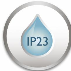
Questa lampada per esterni Philips è appositamente progettata per ambienti esterni umidi ed è stata rigorosamente testata per garantire la sua impermeabilità. Il suo grado di protezione IP23 significa che è stata progettata per offrire protezione contro spruzzi d'acqua ed è quindi ideale per illuminare una veranda o un portico.
