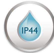
Этот уличный светильник Philips создан специально для работы в условиях повышенной влажности и прошел строгую проверку степени водозащиты. Степень защиты IP обозначается двумя цифрами: первая указывает уровень защиты от пыли, а вторая — от воды. Этот светильник соответствует стандарту IP44: он защищен от брызг и идеально подходит для использования вне помещений.
